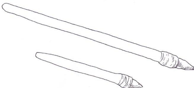
**Trapano primitivo** che serviva a bucare ossi, legno, conchiglie, pietre, ma anche per accendere il fuoco. Funzionava avvolgendo la corda dell’arco attorno al bulino. Quando si spostava avanti e indietro l’arco, il bulino girava vorticosamente e forava il materiale sottostante o faceva scoccare la scintilla.
